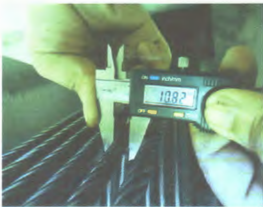
现已磨损的钢丝绳直径
