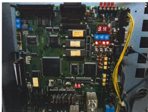
图 6: P1 电子板老化
