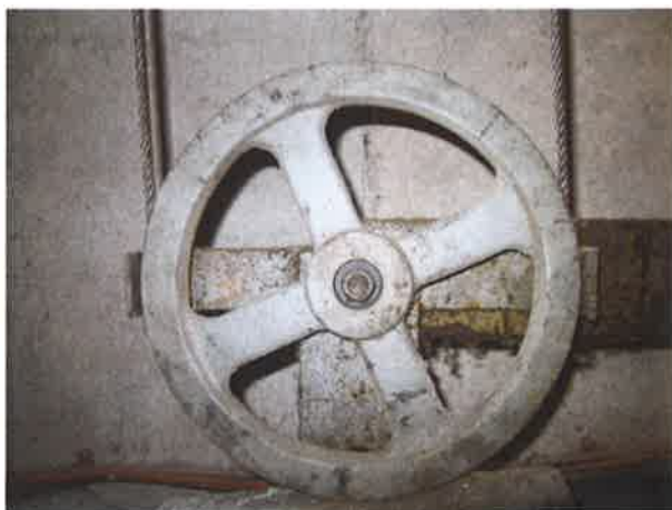
图 28: 张紧轮无防止异物进入的防护装置
