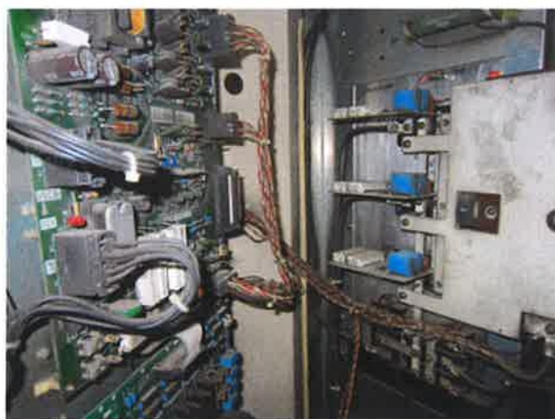
图 5: 调速装置老化且有积尘积碳
