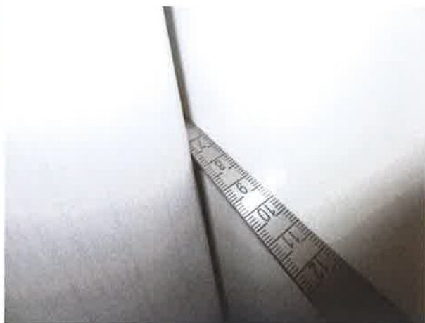
图 26: 门扇与立柱间隙大于 6mm
