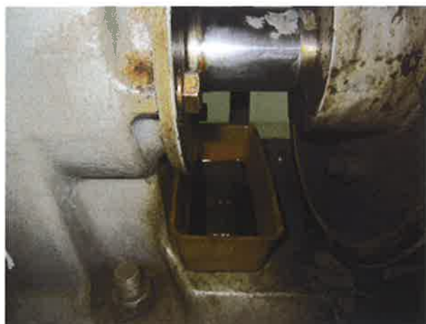
图 14: 减速箱存在渗漏油现象
