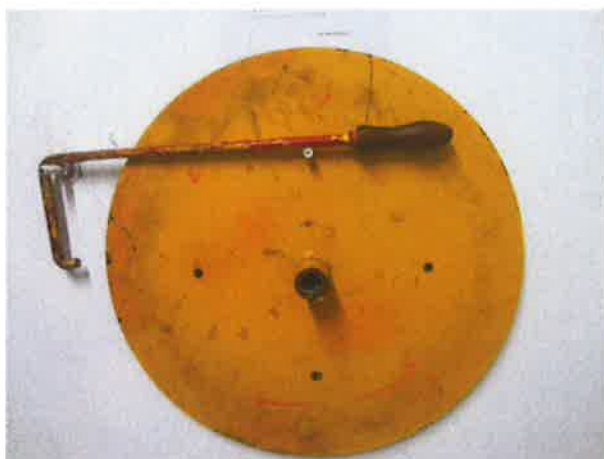
图 13: 可拆卸盘车手轮无相应电气开关
