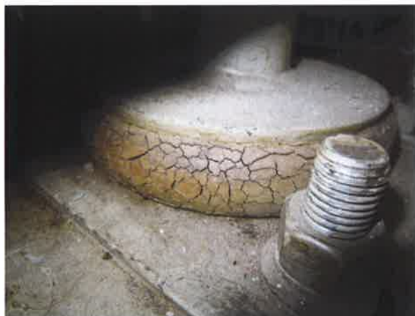
图 16: 主机减震胶老化龟裂
