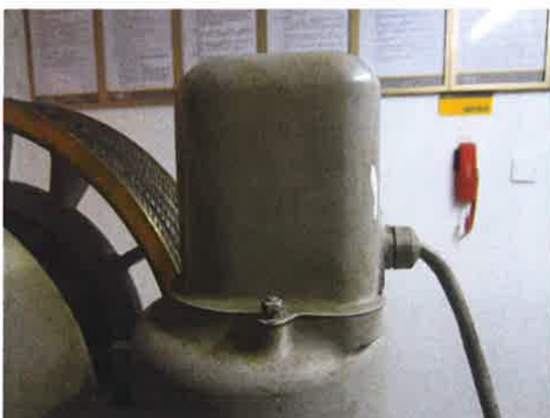
图 17: 制动器仅由一组机械部件（铁芯）组成
